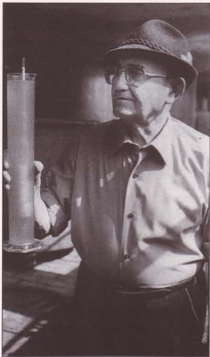
Foto: Markus Weiffenfels „Chef“ van Nahmen mit einem Öchsle- meßgerät zur Bestimmung des Zucker- gehalts des Mosts nach Öchsle-Graden.
